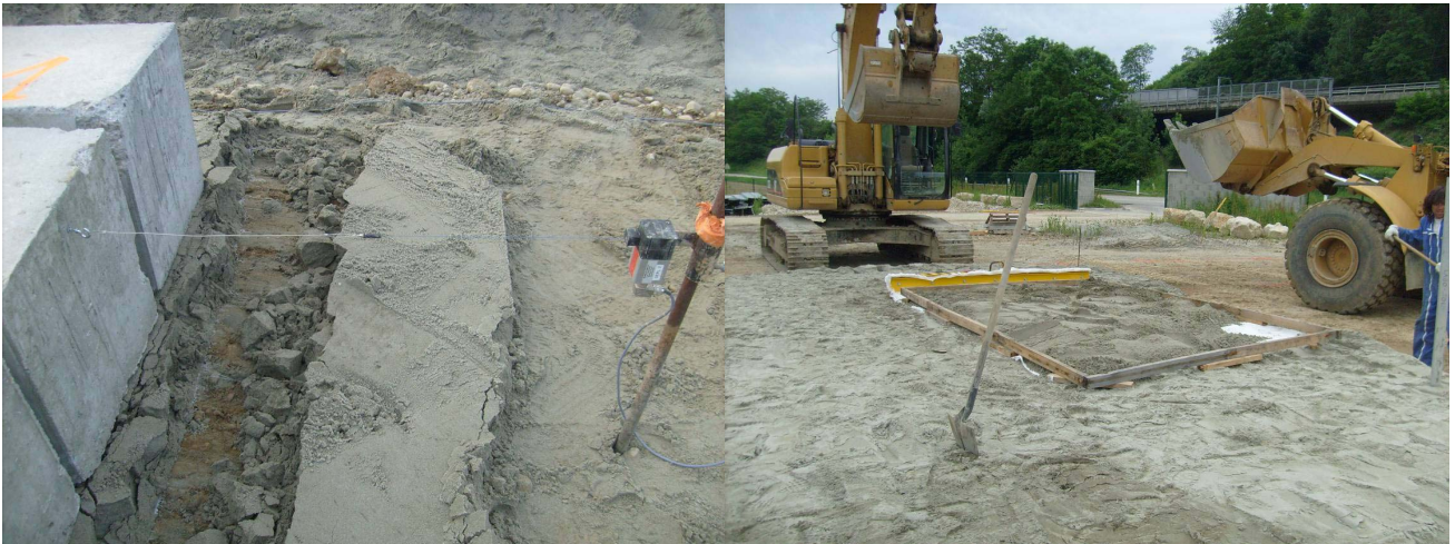
Figure 8. Photos de la mesure de déplacement et de la préparation de l'interface.
