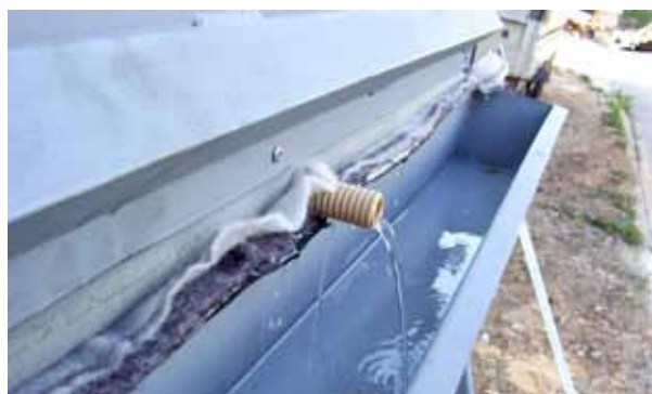
Photo 2 : Les écoulements dans la partie non tissée sont perpendiculaires aux mini-drains (pas ou peu d'écoulement sortant de la partie non-tissée et sens de pose inversé lors d'une expérimentation avec alimentation en eau par le haut)
