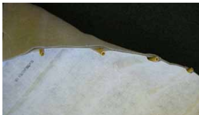
Photo 1 : Structure des géocomposites de la gamme SOMTUBE 850 FTF D20
