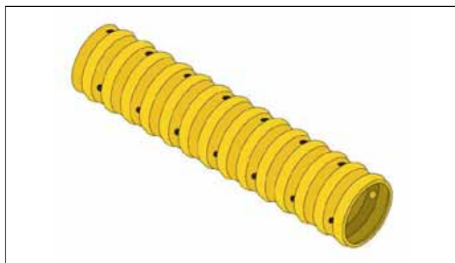
Figure 2 : Structure des mini-drains
